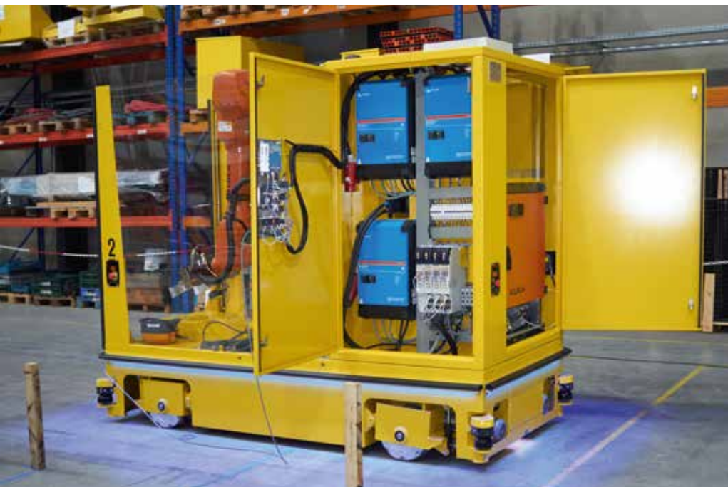
De mobiele robot moet door een gang in een bestaand gebouw en vergt dus een compacte en wendbare AGV. (Foto LDS)
