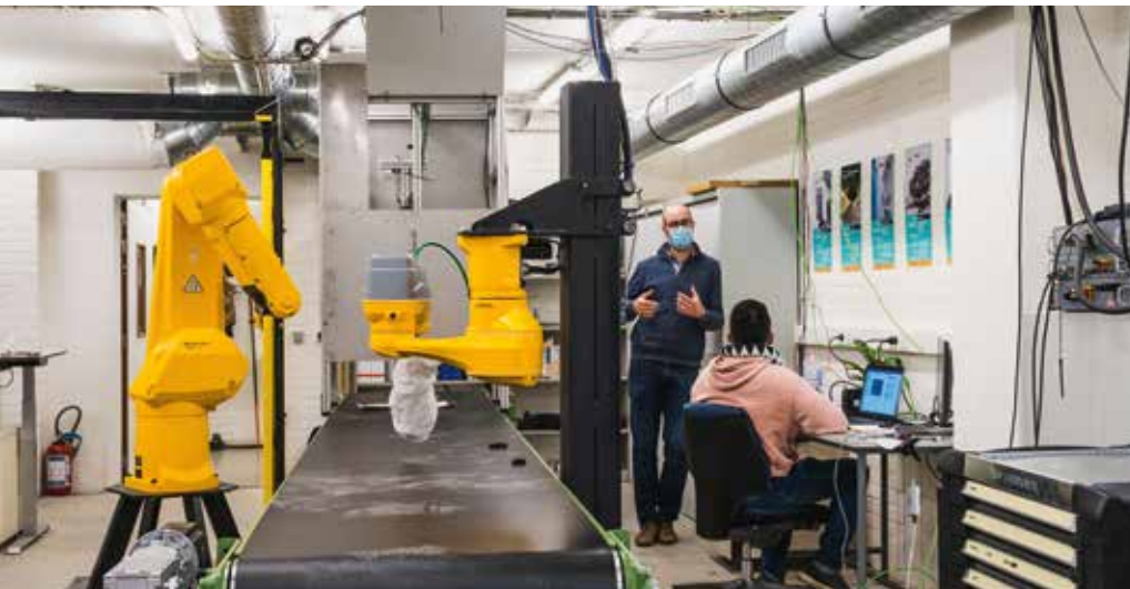
Tegen het eind van het jaar wil men in het labo aan duurtesten beginnen. Verschillende grippers zullen dan in een volcontinue werking in functie van de eigenschappen van de te sorteren objecten met elkaar vergeleken worden. (Foto Louis Lammertyn)
