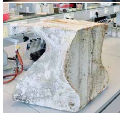
Composietmateriaal gevormd met behulp van robotische wire-cutting fabricatie. (Foto Elise Elsacker, VUB)
