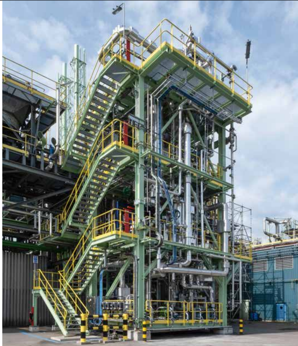
De Qpinch unit op de LDPE productiesite van Borealis in de haven van Antwerpen die restwarmte omzet in processtoom. (Foto Borealis)
